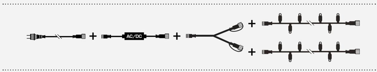
Pour votre installation individuelle et appropriée du système d'éclairage, vous trouverez les accessoires adéquats dans les pages suivantes. Tous nos systèmes d'éclairage doivent toujours être utilisés avec un convertisseur et une fiche secteur. Veuillez noter que les convertisseurs ont une capacité maximale de 460 watts et que la longueur du câble ne doit pas dépasser 120 mètres.
